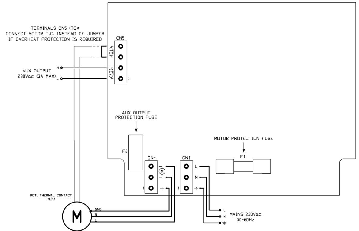
Fig.1 Schema delle connessioni
