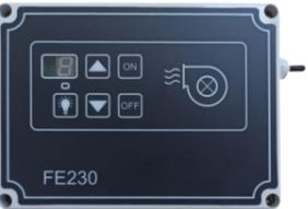
Il regolatore FE230/TI è un avanzato sistema elettronico di controllo a microprocessore dedicato alla regolazione manuale o automatica della velocità di un motore monofase ad induzione (tipicamente destinato ad applicazioni di aspirazione dell'aria), alla gestione dell'impianto di illuminazione e di un'elettrovalvola dell'erogazione del gas (o altra tipologia di carico come, ad esempio, un'elettrovalvola esterna per l'apertura di un camino).
